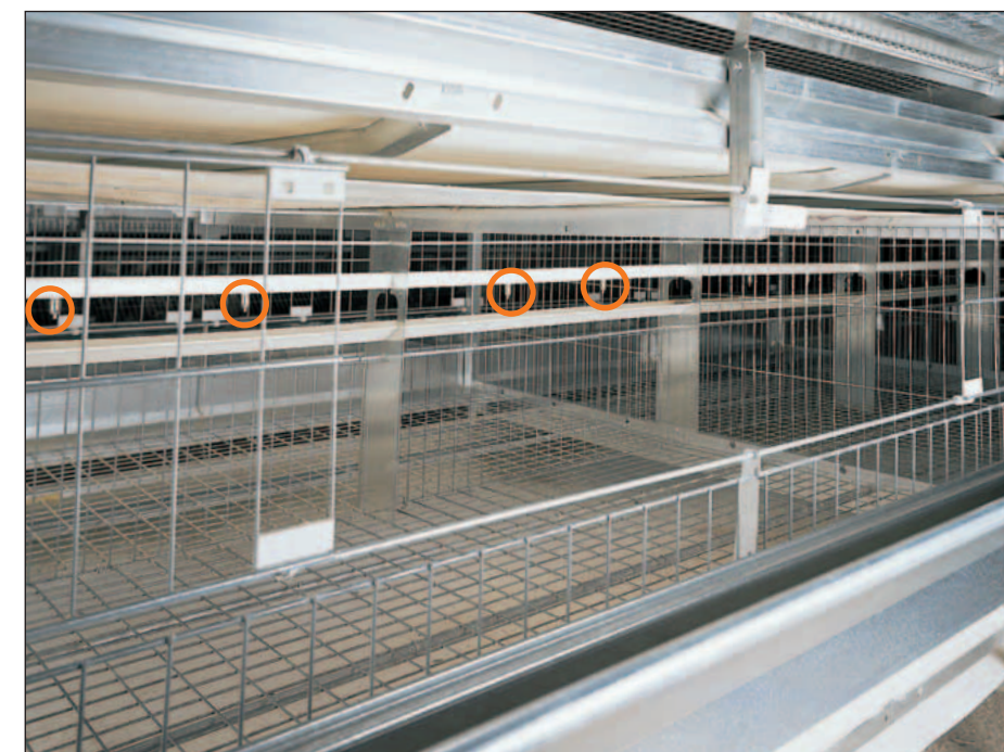
Piso de recría de UV-S 630 – 4 bebederos de acero inoxidable proveen las polluelos de agua potable y fresca
