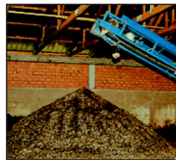
El almacenamiento del estiércol permite una mayor reducción del contenido de humedad.
