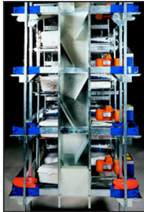
El diseño de la columna permite que el alimento caiga en forma de cascada manteniendo un flujo uniforme y haciendo que la limpieza sea más fácil.
