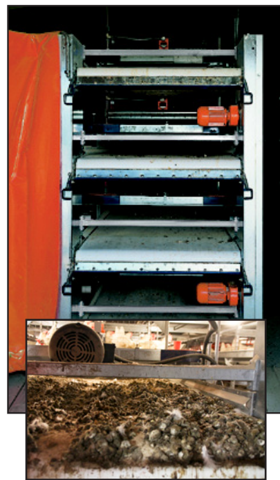
Las cintas mueven el estiércol desde abajo de las jaulas al área de almacenamiento de estiércol.
